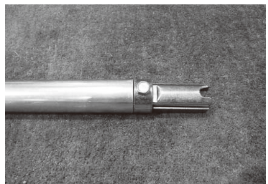
写真2 ボンジョイントを使用して、片側のみに単管を接続した状態。
